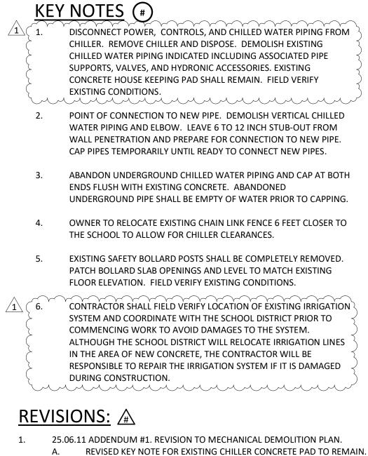
REVISED KEY NOTE FOR EXISTING CHILLER CONCRETE PAD TO REMAIN. B. ADDED KEY NOTE FOR EXISTING IRRIGATION SYSTEM; CONTRACTOR SHALL
